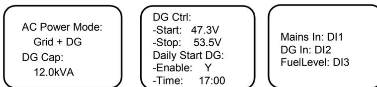
Figure 4-43 DG parameter setting screen
